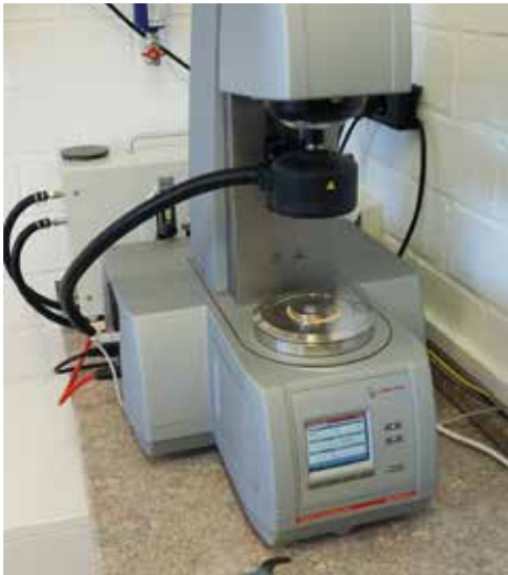
Christian Hauke, Leiter des STORZ-Zentrallabors, am neuen DSR, dem Dynamischen Scherrheometer.
