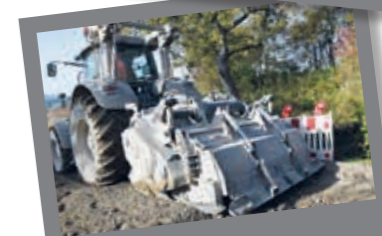
Traktorfräse TYP: FAE MTH 225 Eigengewicht 8 to Mit Wasserberieselung
