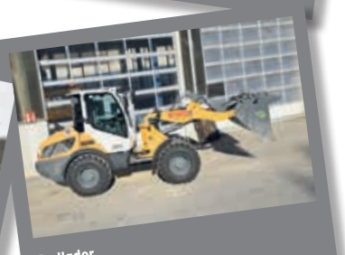
Radlader Typ: Liebherr L 506 Einsatzgewicht 5 to Nennleistung 48 kw
