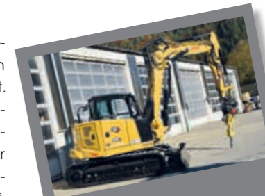
Minibagger CAT 309 CR Einsatzgewicht 9 to Nennleistung 52 kw Mit schwenkbarem Kingshofer Schnellwechsler
