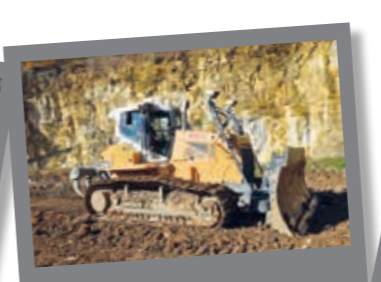
Planierfräse Typ: Liebherr PR 736 Einsatzgewicht 25 to Nennleistung 160 kw
