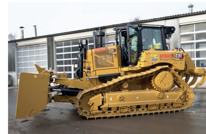
Seit 2023 auch bei STORZ im Bestand: Die Planierraupe CAT D6 XE mit diesel-elektrischem Antrieb.
