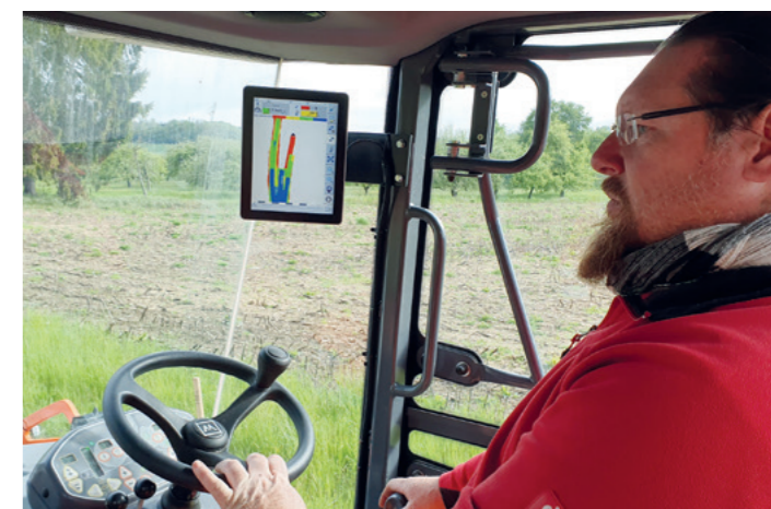
Erstmals rüstete STORZ 2019 vier Walzen für den Asphaltbau mit dem digitalen Kontrollsystem aus. Es misst exakt die Anzahl der Überfahrten.
