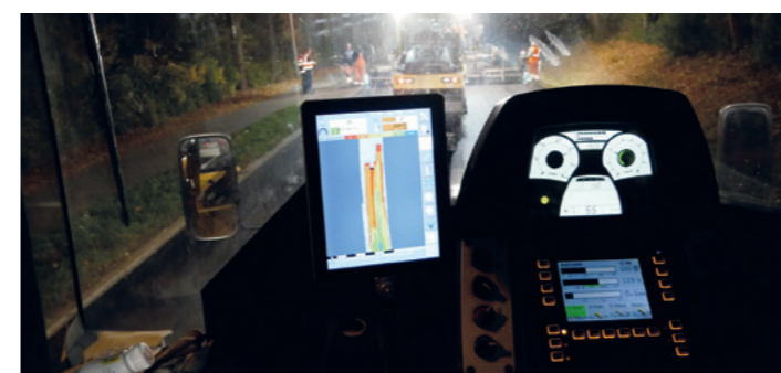
Die Flächendeckende Dynamische Verdichtungskontrolle erhöht die Einbauqualität und die Langlebigkeit der Straße.
