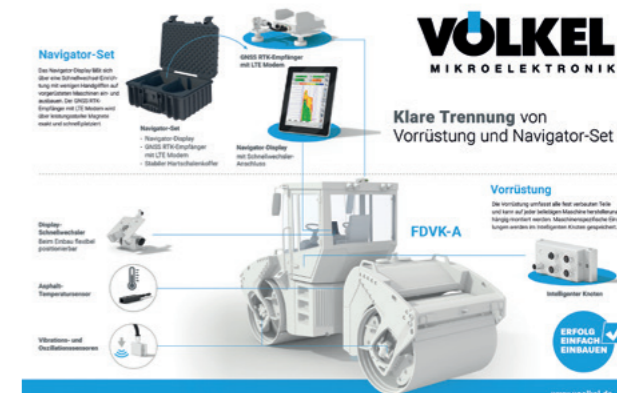
So werden die einzelnen Bauteile in eine Walze integriert.
