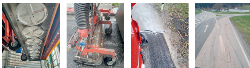
Drehjet mit Flächenabsaugung und Hochdruckreinigung mit rotierenden Düsen bis 200 Bar auf beiden Seiten.
