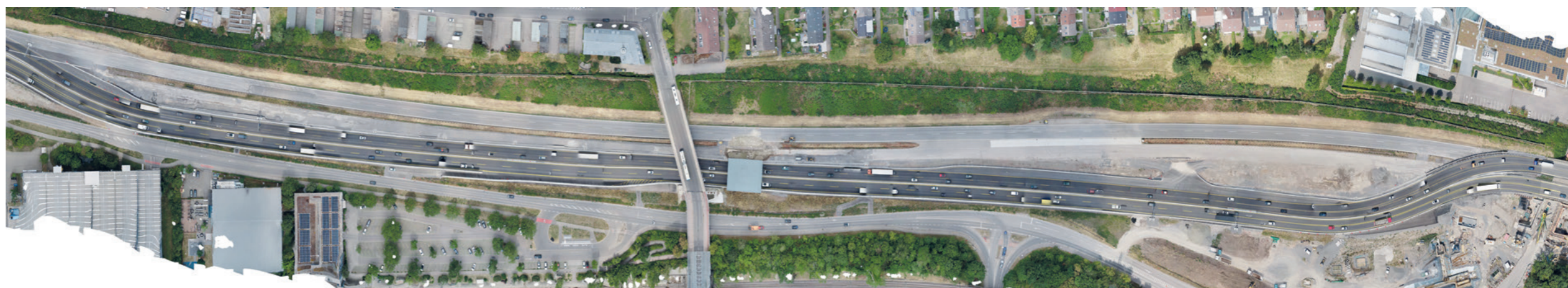
Das Baufeld für den künftigen Tunnel verläuft auf der alten Trasse der A81. Die Autobahn wurde provisorisch nach Süden verlegt. Rechts unten die Einrichtungsfäche mit den Bürocontainern.
