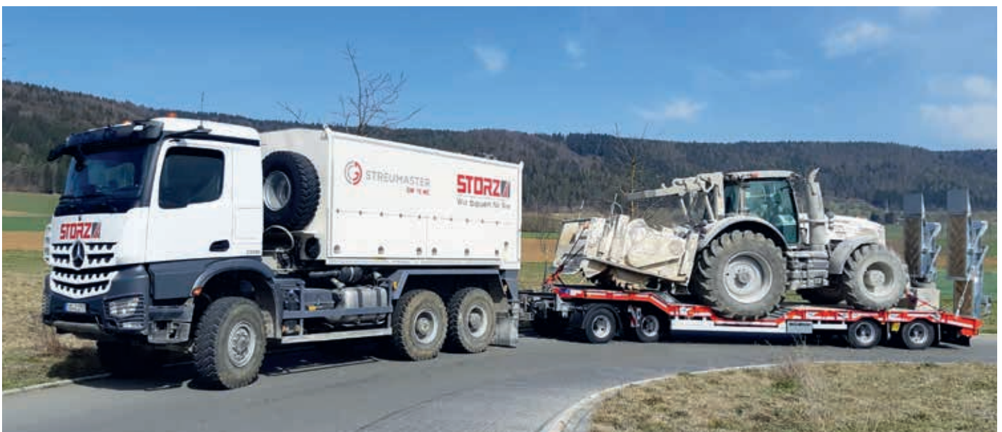
Die neue STORZ-Bodenverbesserungseinheit: Der Mercedes-Arocs ersetzt den bisherigen Traktor und dessen Kalkungsanhänger. Er dient gleichzeitig als Zugmaschine.
