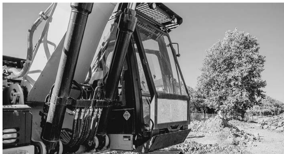
Die Mietstation Böblingen stattete den Kettenbagger mit Panzerglas und Bodenplatte aus.
