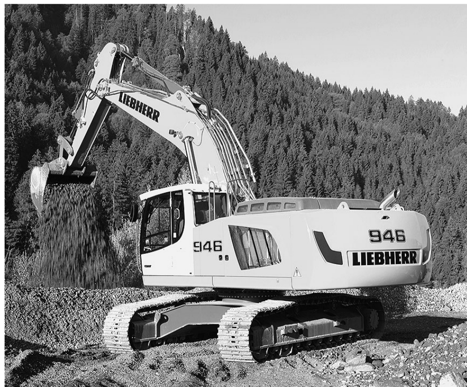
Der neue R 946 ist der erste Raupenbagger von Liebherr, der die Abgasemissionsrichtlinien der Stufe 4/Tier 4f erfüllt. Foto: Liebherr
