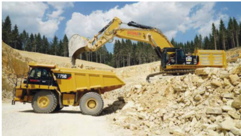
Nur wenige Füllungen des Tieflöffels sind nötig, dann ist der neue Kipper mit Jurakalk beladen. 42 Kubikmeter Material fasst die Mulde.
